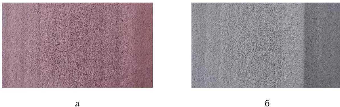
Рисунок 5.13 – Поверхность прекурсорного покрытия, полученного методом холодного напыления: а – Cu-SiC; б – Al-SiC
