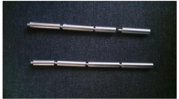
Рисунок 4.12 – Образцы для проведения коррозионных испытаний в потоке свинца: а – эскиз образца; б – внешний вид образцов
