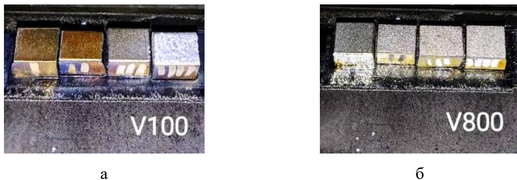
Рисунок 4.56 – Внешний вид образцов после лазерной обработки: а – скорость сканирования 100 мм/с; б – скорость сканирования 800 мм/с
