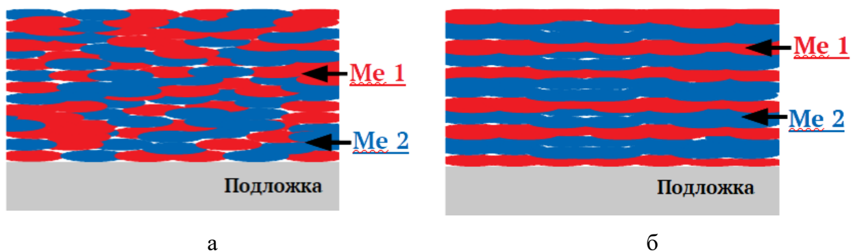
Рисунок 3.1 – Схема прекурсорного покрытия: а - с гетерогенной структурой; б – с многослойной структурой
